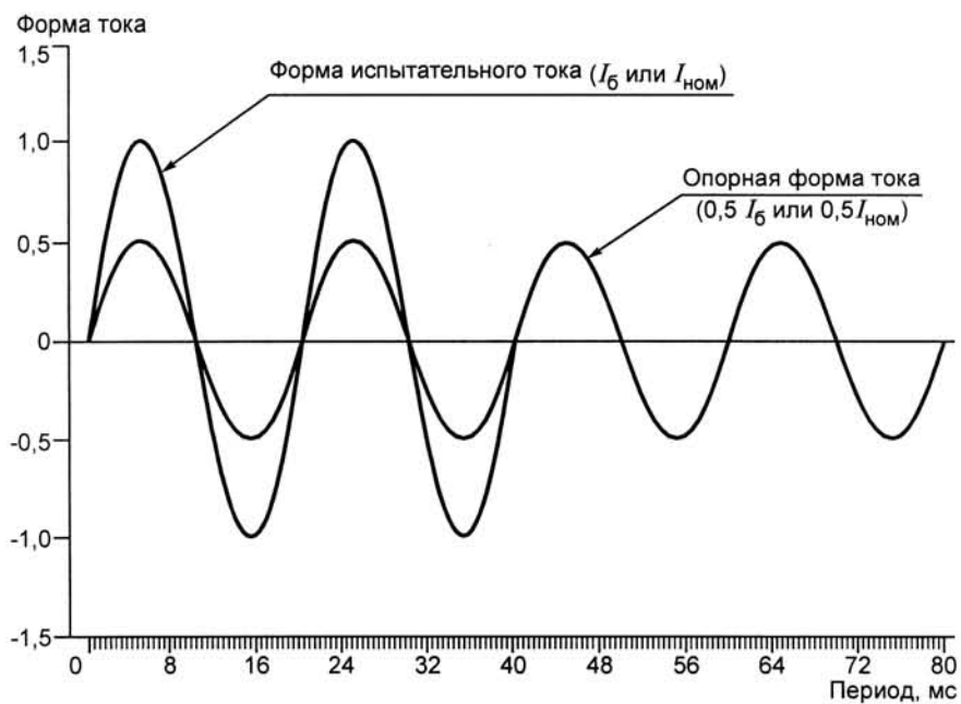
Рисунок А.7 — Форма тока при управлении «пачками периодов»
